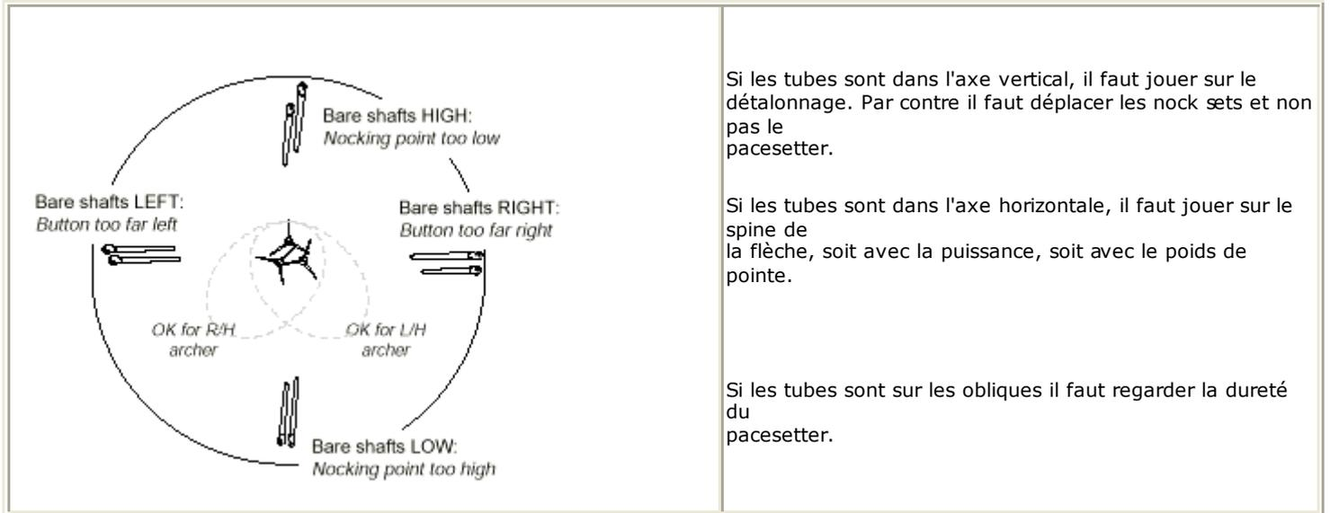
Si les tubes sont dans l'axe vertical, il faut jouer sur le détalonnage. Par contre il faut déplacer les nock sets et non pas le pacesetter.
