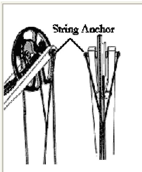
Du fait d'avoir un "écarteur de câble, les poulies ne sont pas droites, mais un peu penchées. Pour un droitier la poulie haute penche à droite et celle du bas à gauche. Pour rattraper cet angle, il faut torsader le split plus d'un côté que de l'autre. Pour contrôler si la poulie est droite, il suffit de prendre une flèche carbone assez fine et droite (donc pas d'ace) et la plaquer contre la poulie. Si la flèche est parallèle à la corde, c'est que la poulie est droite.
